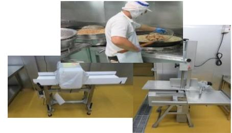
製程管制點監測、金檢機確保金屬混入...等等
